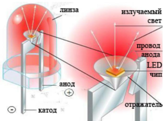
Светодиодные лампы отличаются от обычных ламп еще и по направлению светового потока. Если обычная лампочка излучает свет равномерно, то светодиодные лампы в зависимости от конструкции могут излучать свет как равномерно, так и с небольшим углом. Лампы с узконаправленным световым потоком отлично подойдут для бра в месте отдыха, например, для чтения книг или просмотра телевизора.
